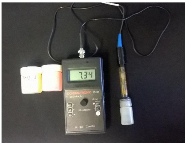
Figura 13: Potenciómetro Conductronic, PC18 usado para medir pH y CE.
