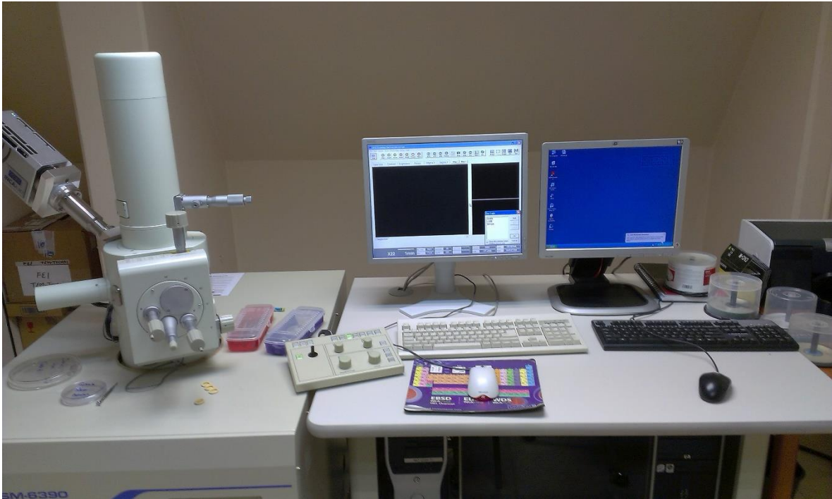
Figura 7. Microscopio electrónico de barrido marca JEOL del Colegio de Postgraduados Campus Montecillo. Imagen propia.
