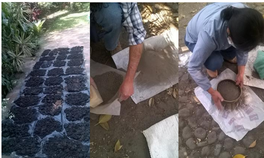
Figura 12. Secado y tamizado de las muestras
