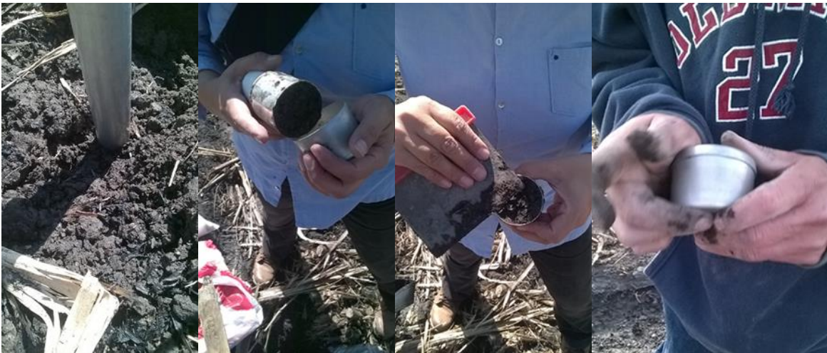
Figura 13. Obtención de las muestras para el método del cilindro.
