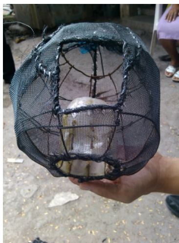
Figura 6. Trampa de alambre y malla mosquitera.
