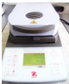
Figura 3.5 Lectura del contenido de humedad
