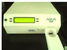
Figura 3.2 Determinación de actividad de agua ( A_w )
