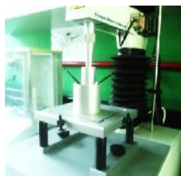
Figura 3.3 Penetración de la punta del texturómetro en medio de la vaina
