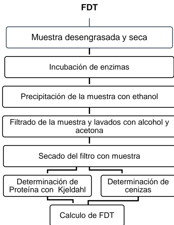
Figura 2.2A Diagrama de proceso para la obtención de FDT
