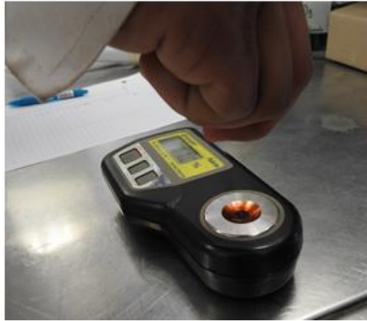
Figura 13. Refractómetro digital para determinar %SST o °Brix en frutos de fresa
