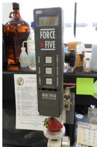
Figura 12. Texturómetro Wagner para determinar textura de en frutos de fresa
