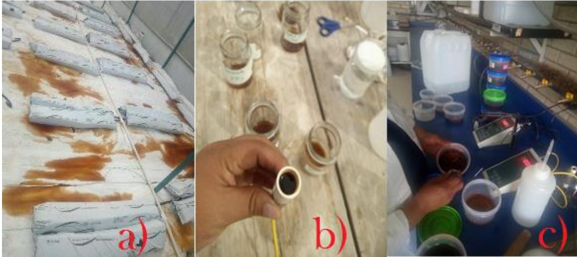
Figura 6. a) Lavados pesados de bolis con agua acidificada. b) Monitoreo constante de CE en invernadero. c) Monitoreo de pH y CE de fibra de coco después de los lavados, realizado en el laboratorio.
