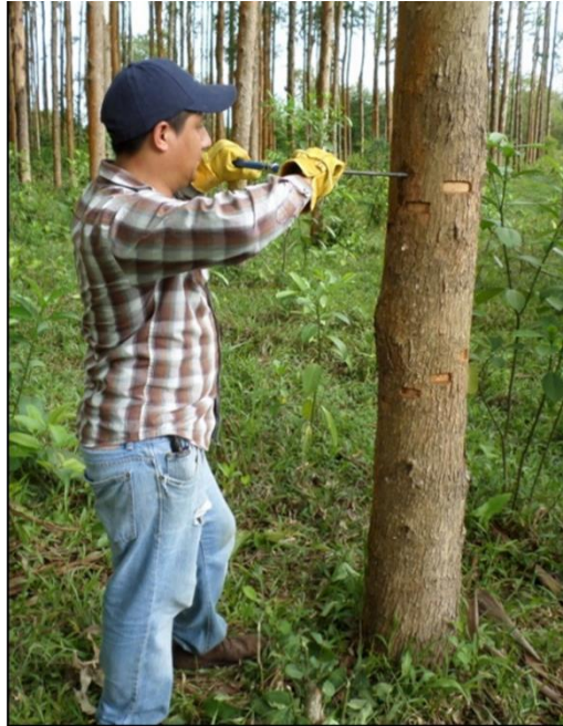
Figura 2.1. Extracción no destructiva de la muestra de madera de Eucalyptus grandis Hill ex Maiden
