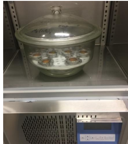
Figura 11. Medición de permeabilidad al vapor de agua (Elcometer, SPRL)
