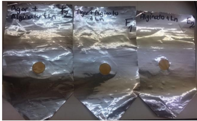
Figura 10. Muestras preparadas para la medición de la permeabilidad del oxígeno (OXTRAN, Mocon)
