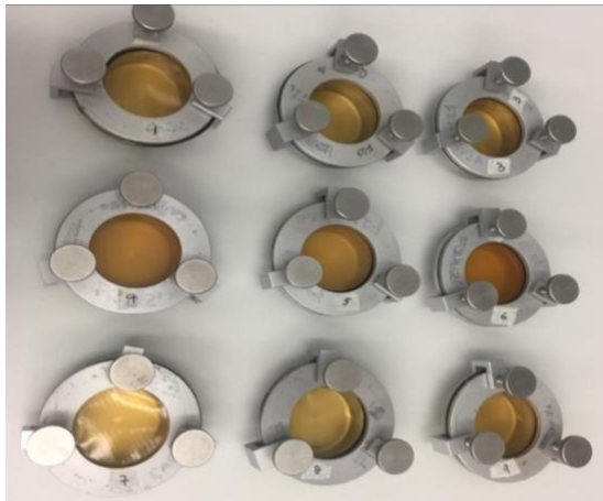
Figura 11. Medición de permeabilidad al vapor de agua (Elcometer, SPRL)
