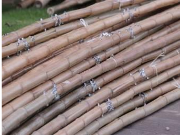
Figura 44. Arcos de bambú armados.
