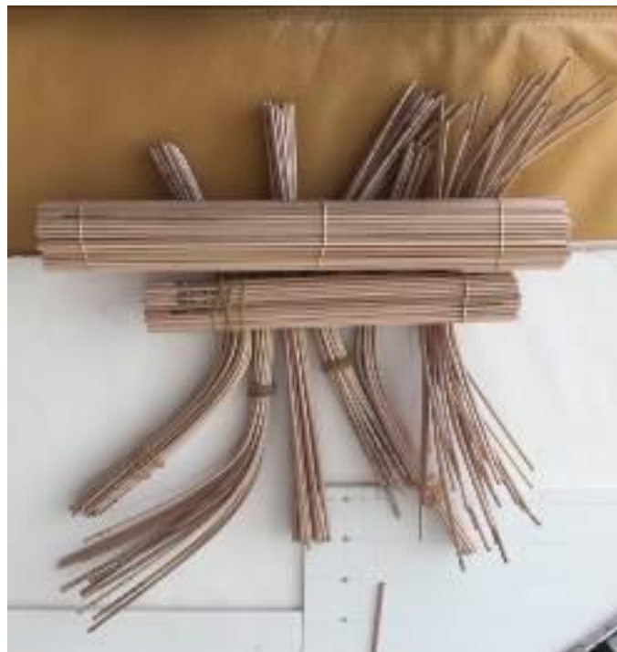
Figura 74. Material para arcos en distintas fases del proceso de curvado.
