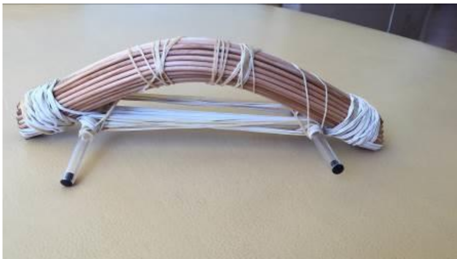
Figura 70. Sistema de curvado de arcos de madera para maqueta 3.
