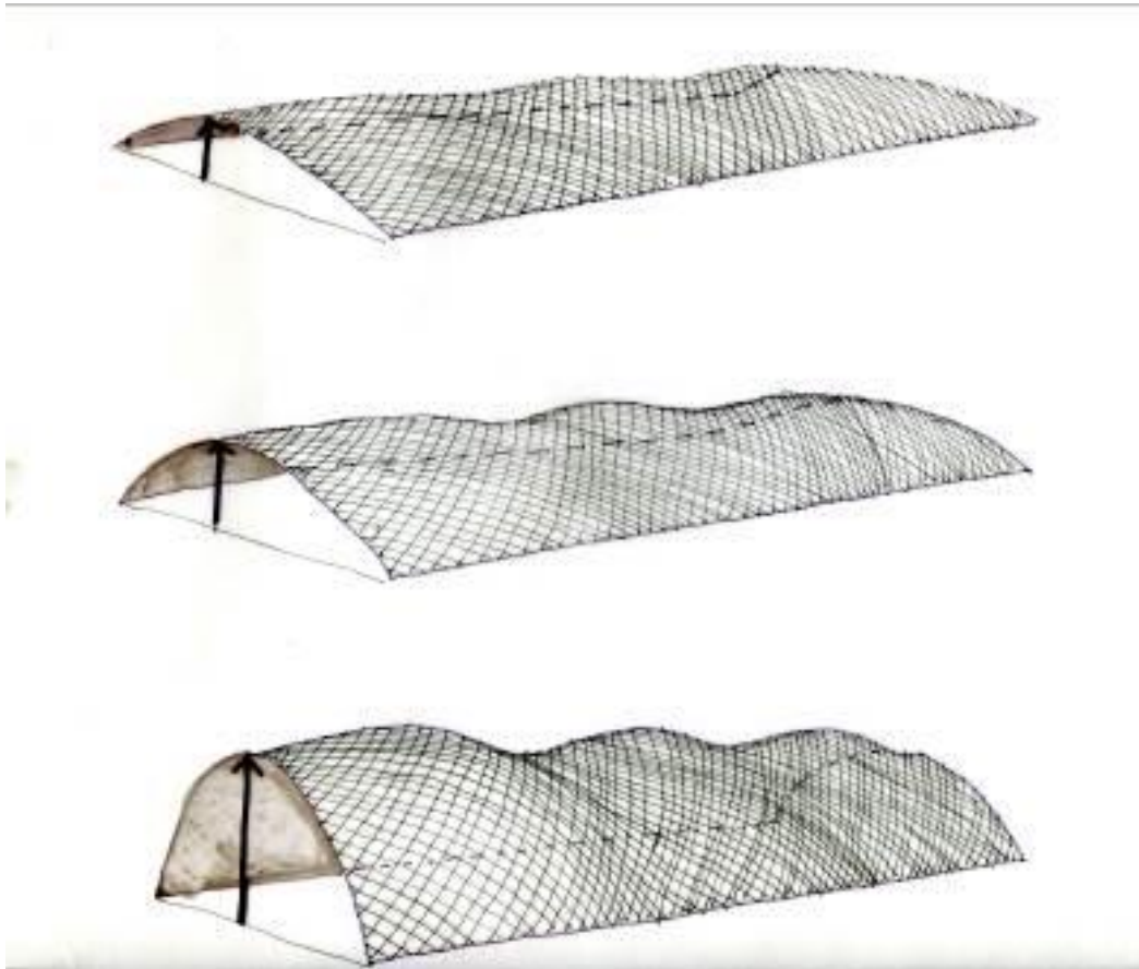
Figura 16. Proceso de montaje para un cascarón reticular.
