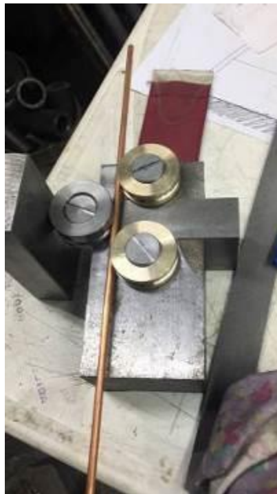
Figura 83. Sistema de curvado de tubería 5/32 para nodos. Antes.
