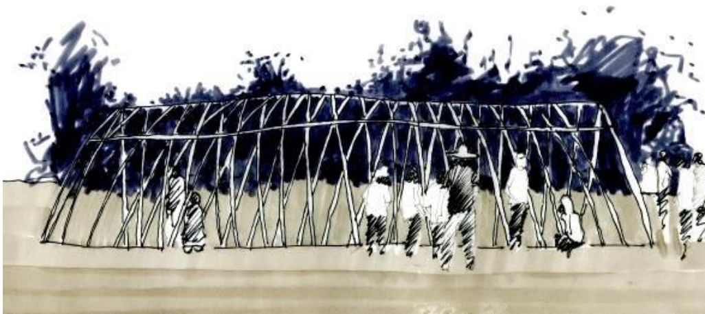
Figura 18. Levantamiento de la retícula de bambú.
