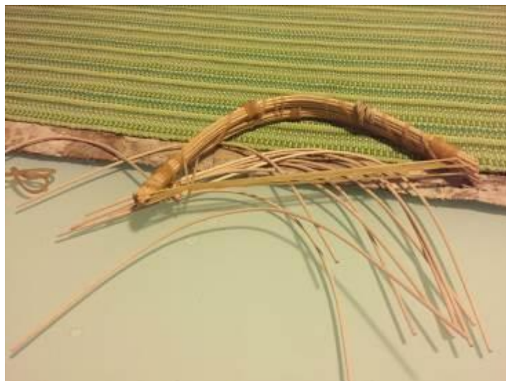
Figura 79. Sistema de curvado de arcos de bambú.
