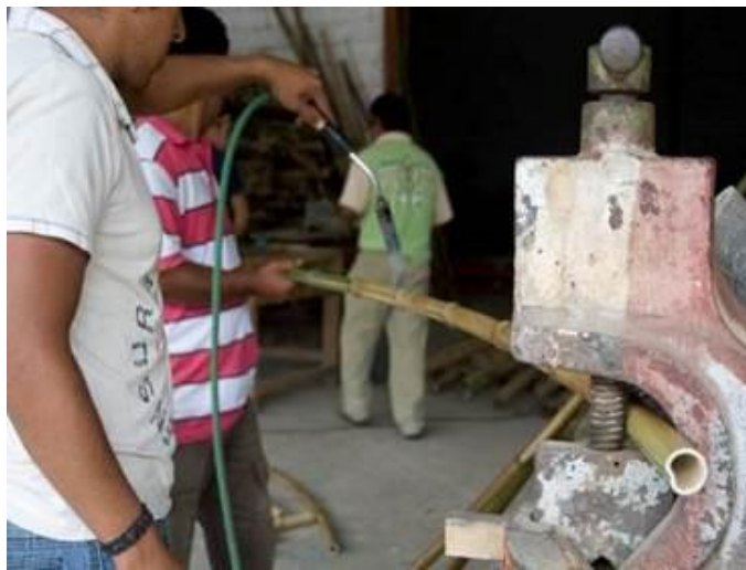
Figura 43. Curvado del bambú con soplete.
