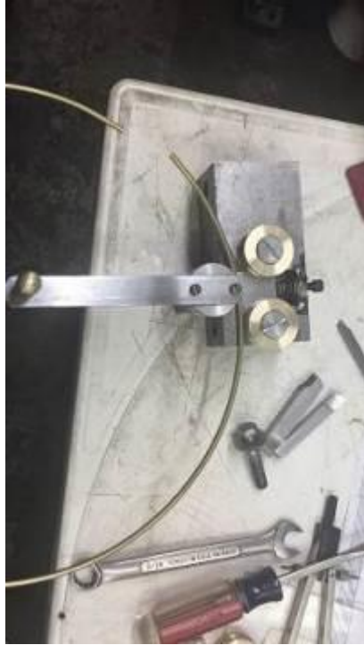
Figura 84. Sistema de curvado de tubería 5/32 para nodos. Después.
