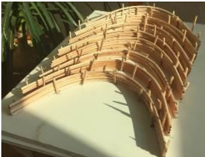
Figura 72. Variación del sistema de curvado de arcos para maqueta 4.
