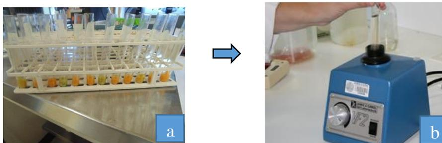
**Figura 12.** Determinación de saponinas: a) aplicación de agua destilada para cada muestra, b) agitación en vórtex.
