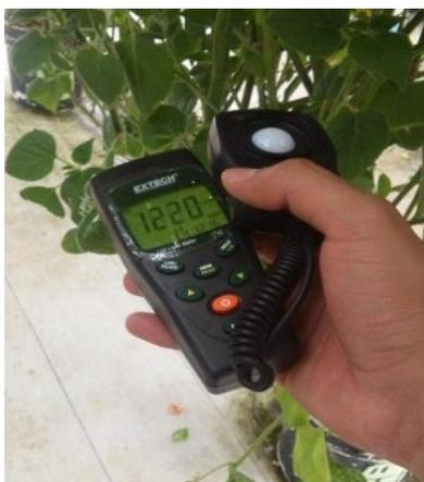
**Figura 4.** Determinación de incidencia de luz con el fotómetro de luces LED LT-45®.
