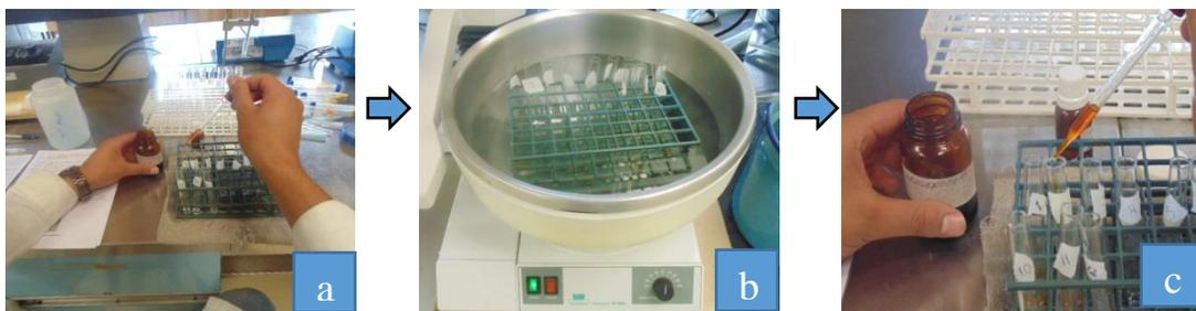
**Figura 11.** Prueba para determinar alcaloides: a) aplicación de ácido clorhídrico, b) baño maría, c) aplicación del reactivo Dragendorff.
