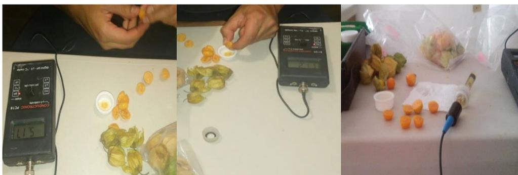
**Figura 6.** Determinación de pH en jugo de frutos de *Physalis peruviana* L. mediante un potenciómetro.
