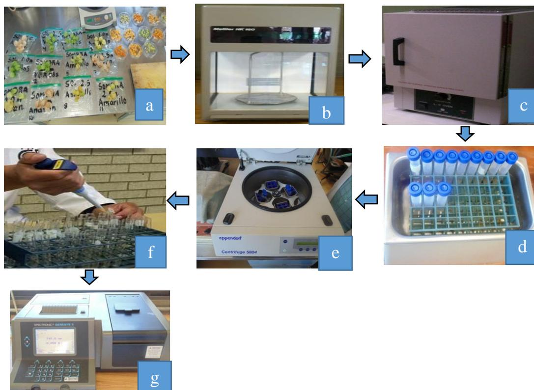
**Figura 17.** Proceso para la cuantificación de fenoles totales en uchuva: a) toma de muestras, b) secado de frutos en estufa, c) pesado de frutos en balanza analítica, d) baño de ultrasonido, e) centrifugación de las muestras, f) aplicación de reactivos, g) lectura en el espectrofotómetro.
