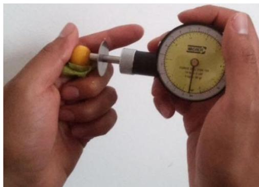
**Figura 9.** Determinación de la firmeza del fruto, con un medidor Force Dial FDK 160.
