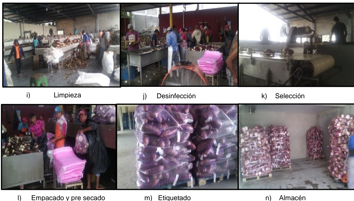
Figura 11. Área de empaque (Limpieza, selección, etiquetado y almacén).
