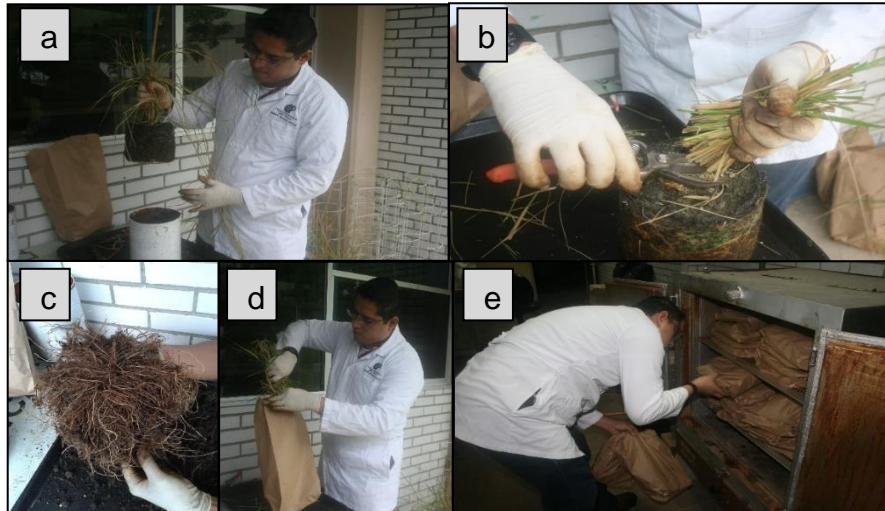
Figura 11. Secado de la biomasa vegetal. a) Suelo y planta contenido en la unidad experimental; b) Corte de follaje; c) Remoción de raíces del suelo; d) Follaje y raíz en bolsas de papel estraza; e) Follaje y raíz en horno (temperatura 65 ° C) por 8 dds.
