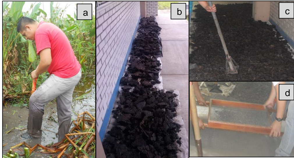
Figura 7. Procedimiento del procesado del suelo. a) Colecta de suelo Ej. Blasillo, segunda sección, Huimanguillo, Tabasco; b) Tendido y secado bajo sombra; c) Molido de suelo d) Tamizado en maya de acero inoxidable de 5 mm de abertura.
