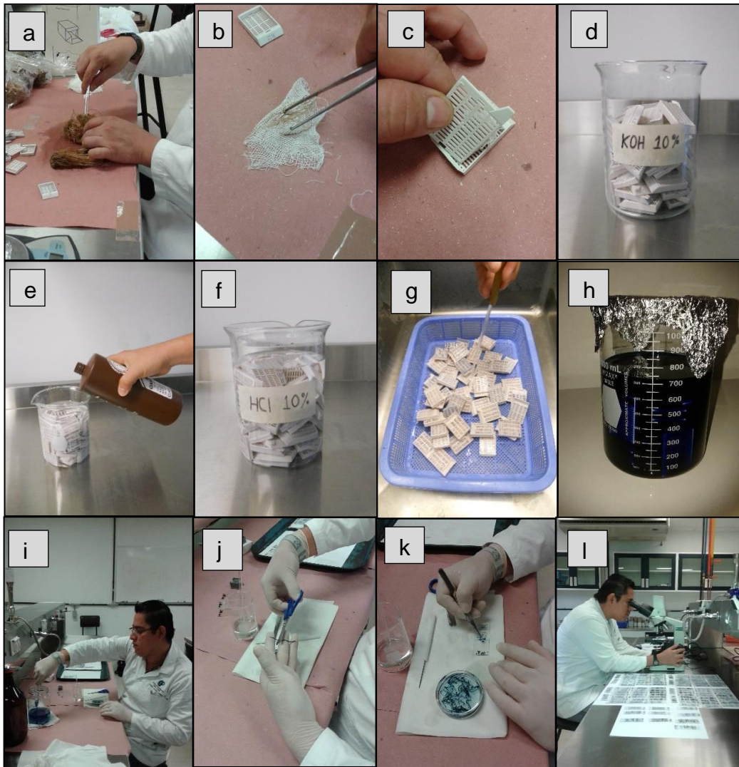
Figura 12. Proceso de clareo y tinción de raíces. a) Selección de raíces; b) Raíces sobre gasa; c) Colocado en capsula para tinción; d) Sumergido en KOH 10 % 72 hrs.; e) Sumergido en H 2 O 2 al 3% [comercial] 10 min.; f) Sumergido en HCl al 10% 5 min.; g) Lavado con agua corriente, h) Teñido con azul de tripano al 0.05 % 72 hrs.; i) Eliminado de exceso de colorante en Lactoglicerol; j) Cortado de raíces para montar; k) Montado de raíces sobre portaobjeto; l) observación en microscopio óptico a 40 X.
