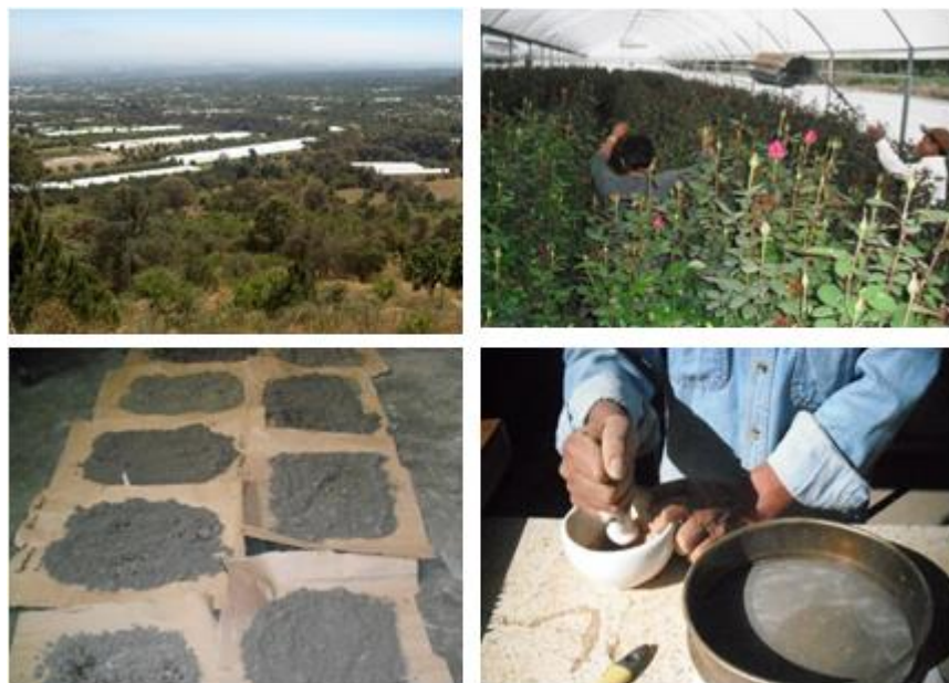
Figura 5. Muestreo, secado y tamizado del suelo.
