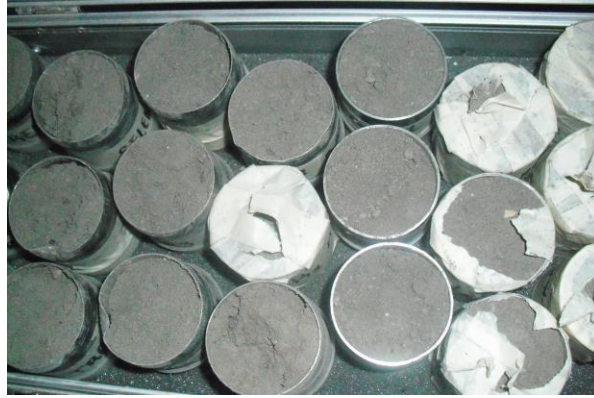
Figura 8. Cilindros de muestreo para la determinación de estabilidad de agregados.
