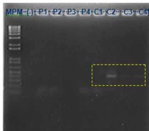
Figura 5.8. Gel de agarosa al 1.5% mostrando fragmentos amplificados de 300 pb aproximadamente de muestras provenientes de Colima con diferentes síntomas. Marcador de peso molecular (MPM), control negativo (-), muestras provenientes de Puebla (P1, P2, P3 y P4), muestras de Colima (C1, C2, C3 y C4).
