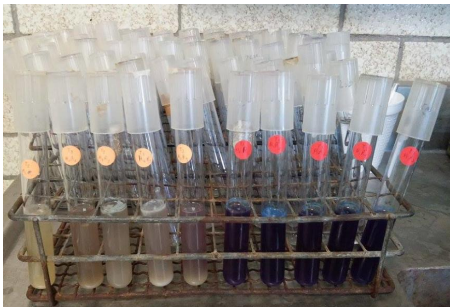
Figura 36. Muestra de agua de lluvia con presencia de Coliformes Totales (Etiqueta anaranjada) y muestra de agua potable con ausencia de estos (Etiqueta roja).
