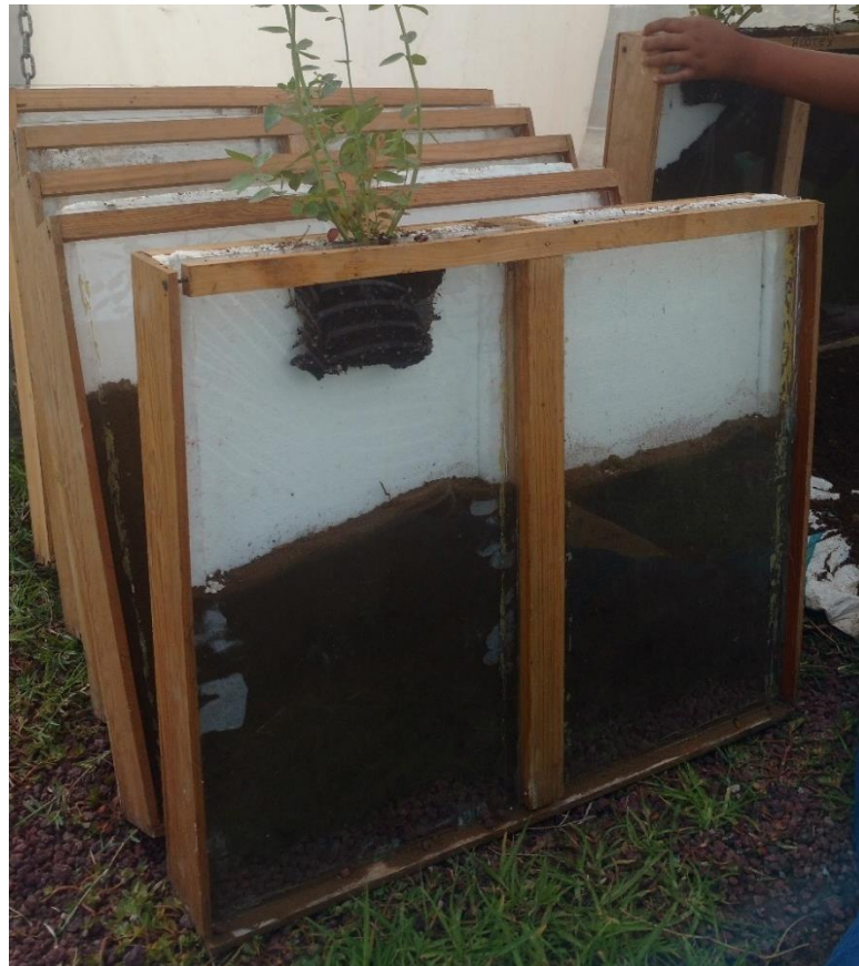
Figura 2. Rizotrones de madera con dos cavidades cada uno
