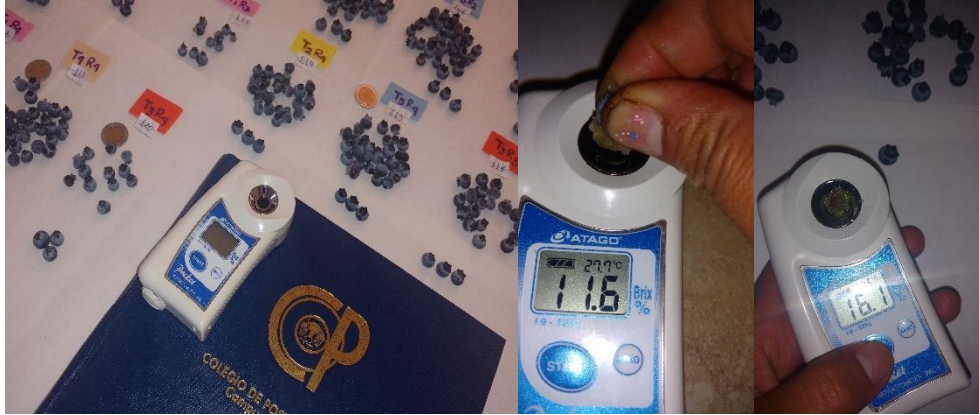
Figura 6. Medición de grados Brix por cada unidad experimental
