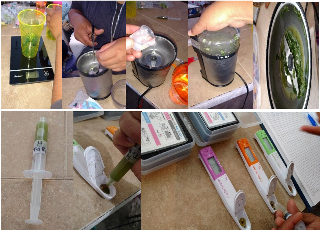
Figura 3. Procedimiento para obtener el extracto celular por cada muestra y realizar las lecturas en los ionómetros específicos de \text{NO}_3^- , \text{Ca}^{2+} y \text{K}^+
