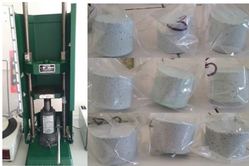
Figura 7. Prensa hidráulica de laboratorio “Carver Press” (izquierda) y bolos intrarruminales de lenta liberación (derecha).
