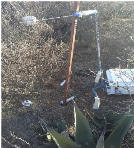
Figura 12. Registrador electrónico y su conjunto de sensores a diferentes alturas colocado en una colonia de Liometopum apiculatum de la UMA El Milagro, Villa González Ortega, Zacatecas.
