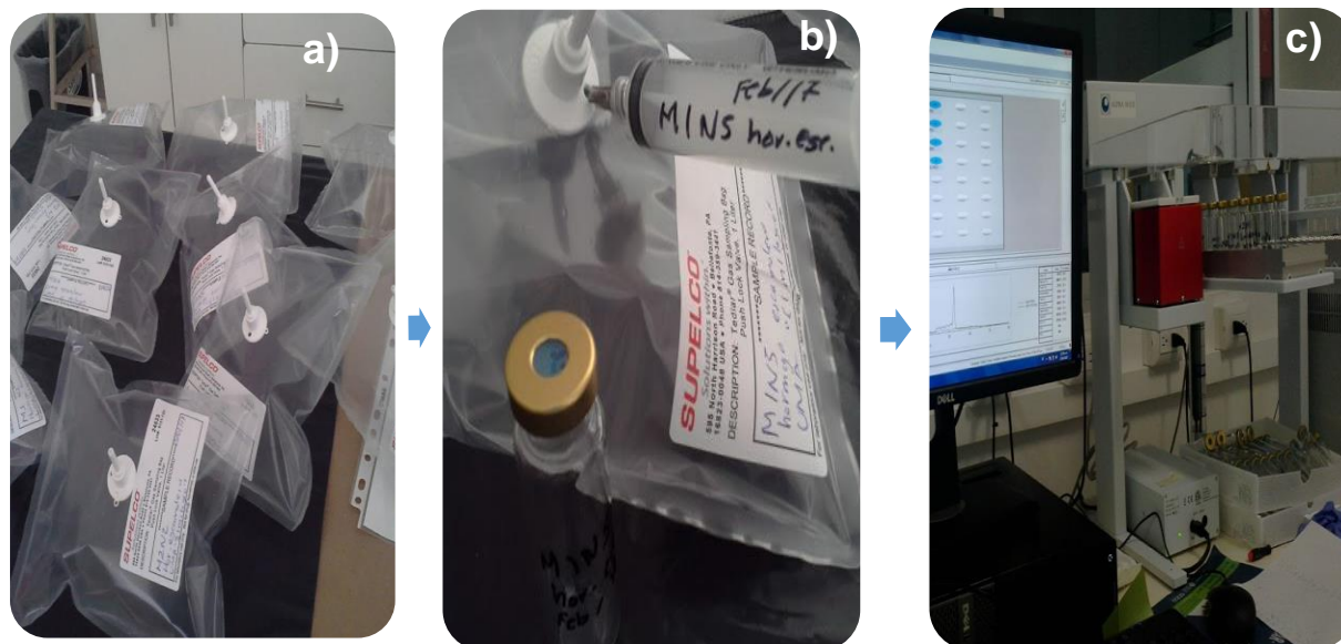
Figura 6. Preparación de muestras de aire para el análisis cromatográfico. a) Incubación durante 10 minutos a 37°C, b) extracción de 40 ml de muestra de las bolsas a viales y c) colocación de viales en la rejilla del equipo.
