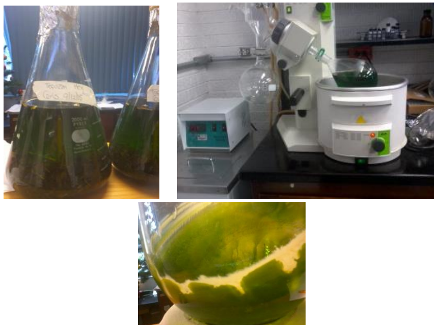
Figura 6. Izq. extracción por maceración; der. rotaevaporador; abajo: extracto seco.
