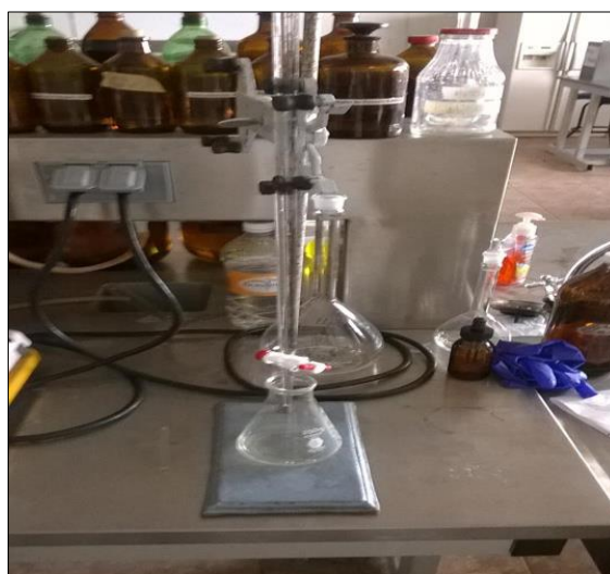
Figura 32. Titulación de la muestra para determinar el índice de acidez.
