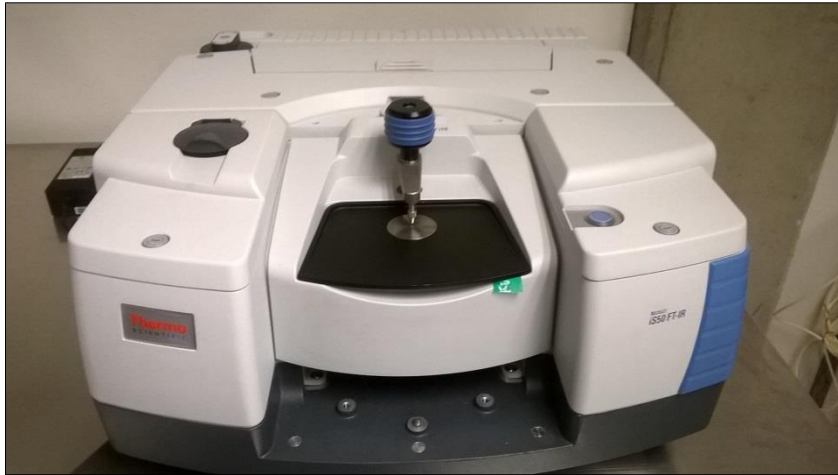
Figura 34. Equipo FTIR utilizado en este trabajo.
