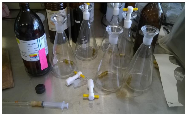
Figura 33. Material utilizado en la determinación del índice de peróxidos.
