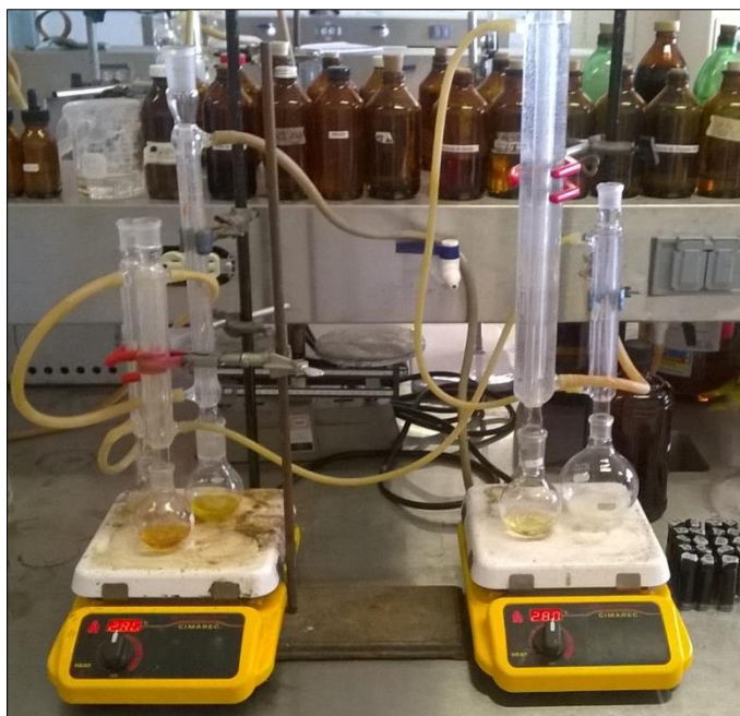
Figura 30. Sistema para determinar el Índice de Saponificación.
