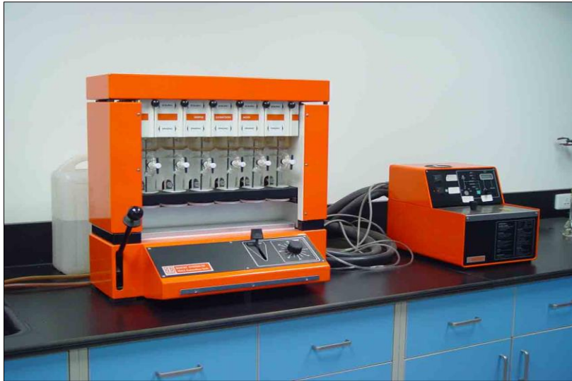
Figura 28. Determinador de grasa y aceite SOXTEC SYSTEM HT
