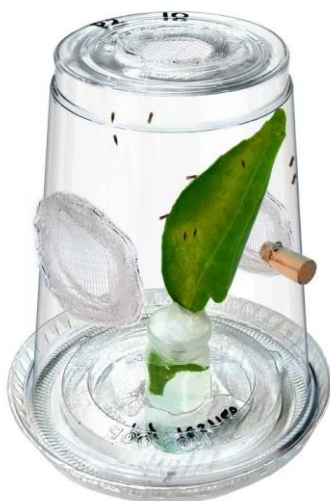
Figura 3. Arena experimental empleada en pruebas de repelencia de adultos de Diaphorina citri (Imagen Valdez y Ortega, 2015).
