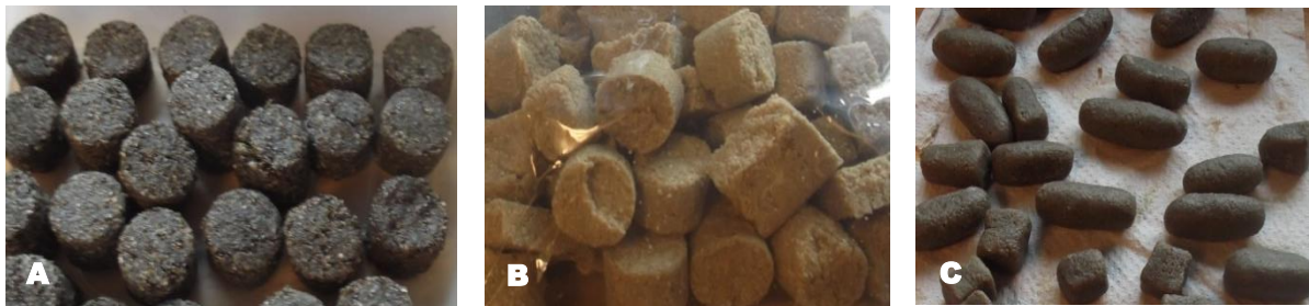
Figura 12. Comprimidos hechos a base de semillas (A: chíá, B: amaranto y C: girasol) y agua destilada.
