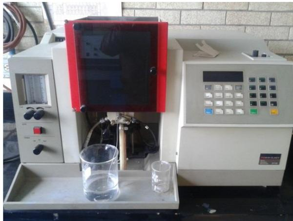
Figura 21. Espectrofotómetro de Absorción Atómica Perkin Elmer.
