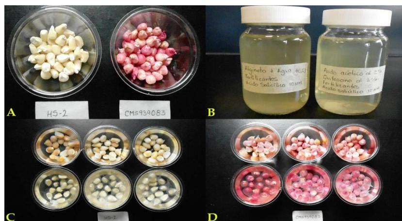
Figura 18. Suspensiones y recubrimientos finales. A) Semillas sin recubrir de las variedades seleccionadas (HS-2 y CMS939083); B) Suspensiones finales (Quitosano 3% y Alginato de sodio 5%); C) Semillas de la variedad HS-2 con los recubrimientos gelificados y D) Semillas de la variedad CMS939083 con los recubrimientos gelificados.
