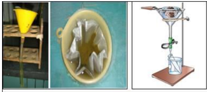
Figura 3.4. Aparato de Baermann, para obtener larvas
