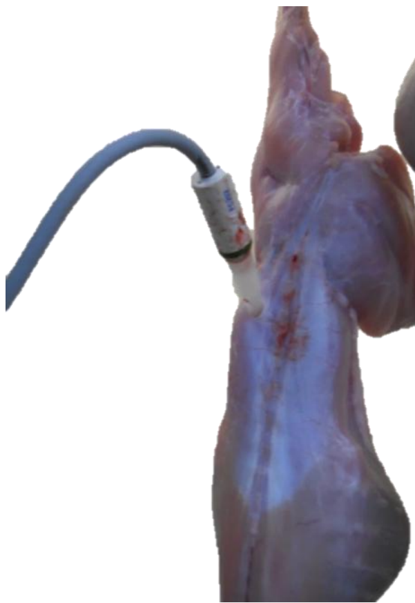
Figura 4.- Colocación del electrodo de punción para la lectura de pH.
