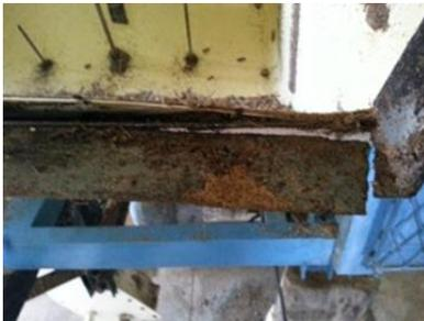
**Figura 18. Partes desoldadas**
