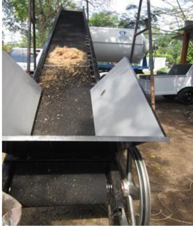
**Figura 3. Banda transportadora de alimento**
