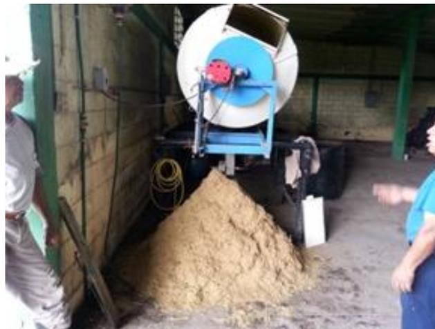
**Figura 5. Descarga del alimento elaborado con el equipo fermentador**
