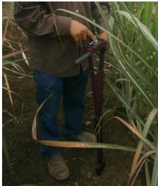
Figura IV. 1. Medición de humedad del suelo (HUM) con el TDR300®. Diciembre de 2013, El Triunfo, Guayaquil, Ecuador.
