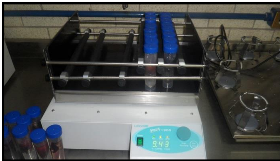
Figura 12. Agitación de la suspensión madre de cálices de 3 variedades de Jamaica (Criolla de Ayutla, China roja y Sudán).
