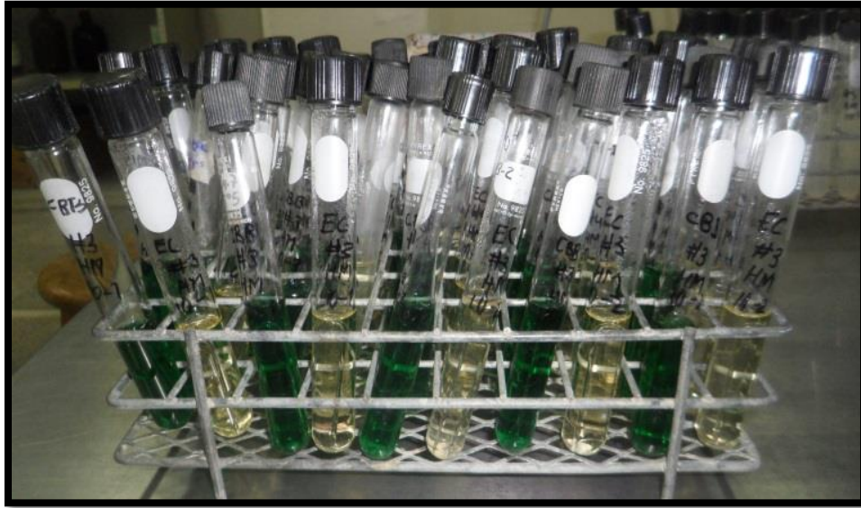
FIGURA 4. Tubos de Caldo bilis verde brillante para confirmación de coliformes totales y tubos con medio EC para confirmación de coliformes fecales.
