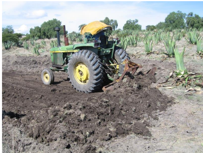
Figura 2. Rastreo para aflojar la tierra y poder retirarla.
