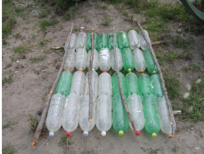
Figura 15. Balsa construida con palos de árbol y botellas.
