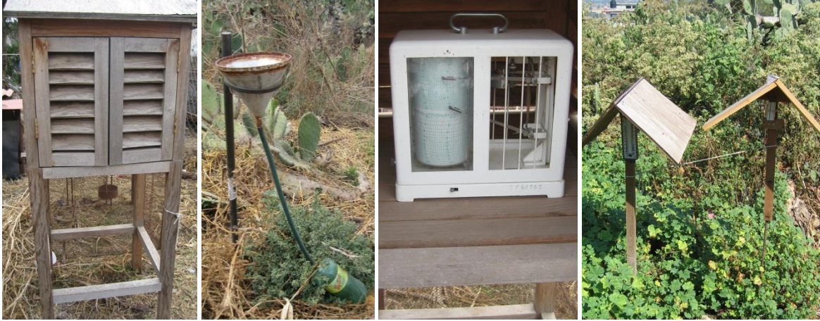
Figuras 9, 10, 11 y 12. De izquierda a derecha: Garita meteorológica, pluviómetro, higrotermógrafo y minidataloger.
