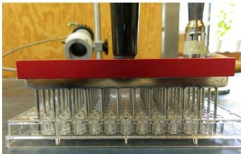
Figura 2. Microplaca de 96 pocillos con el inoculador multipunto y la fuente de inoculo bacteriano.
