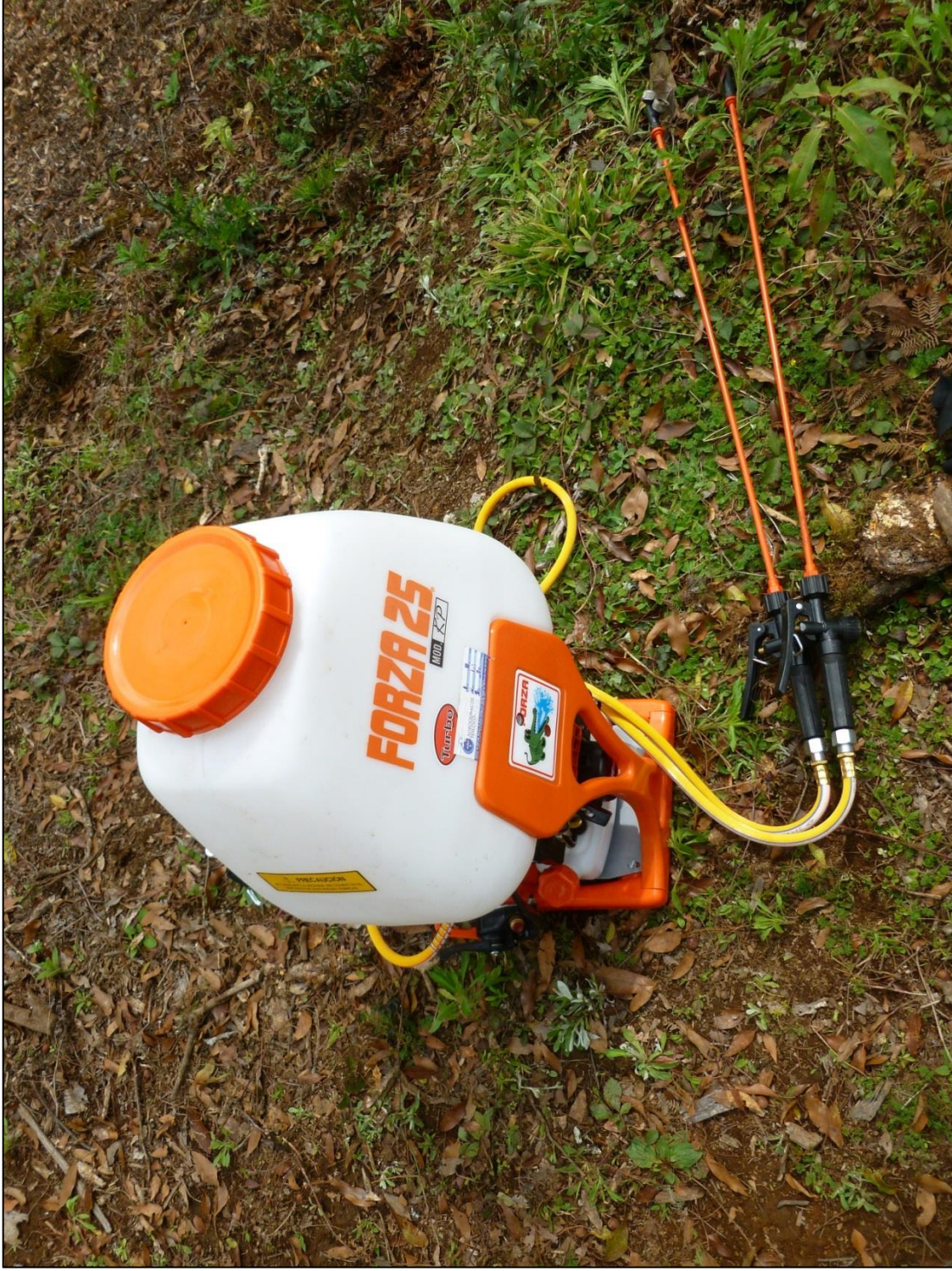
Figura 20. Aspersora motorizada FORZA 25 utilizada para efectuar la aplicación de los tratamientos. Fecha: 16 de febrero del 2012.
