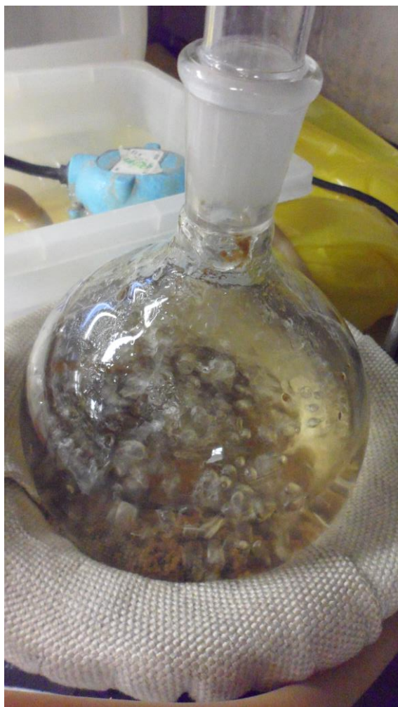
Figura 2. Material vegetal macerado y sometido a extracción a reflujo con hexano.
