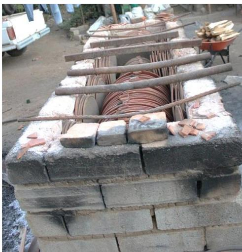
Figura 11. Horno cuadrado y construido con block con capacidad de 100 comales
