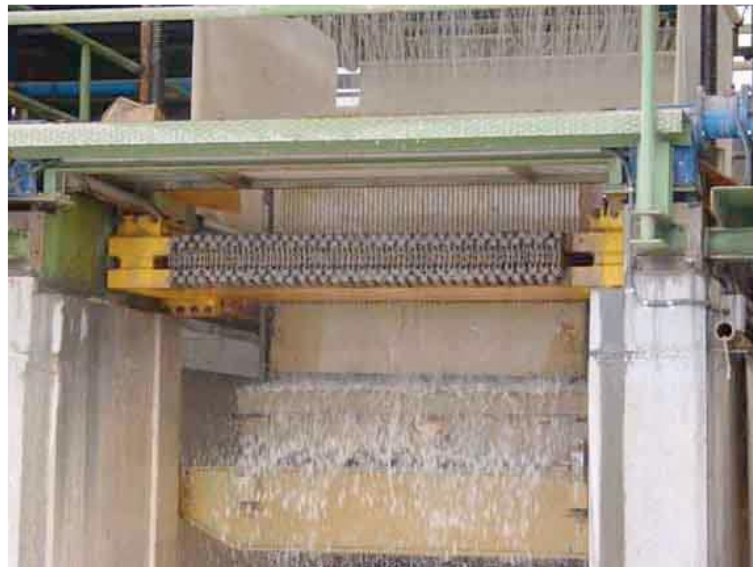
Figura 22. Telar para aserrado de bloques de mármol Foto: Mario Miranda Trejo
