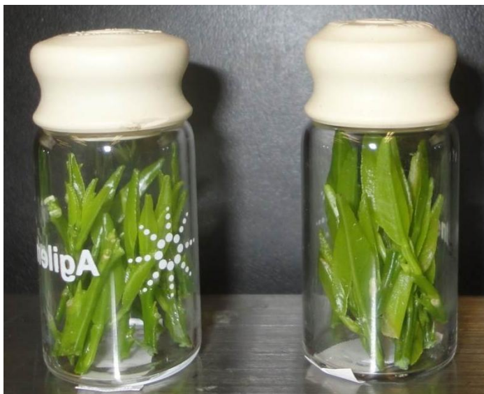
Figura 4. Brotes colocados en viales Agilent® de 10 ml para SPME.
