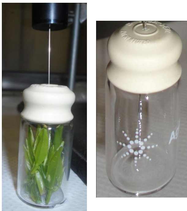
Figura 5. Fibra para SPME de polidimetilsiloxano.
