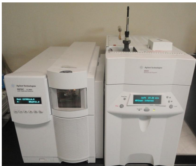
Figura 9. Cromatógrafo de gases acoplado a un detector selectivo de masas (CG-DSM).
