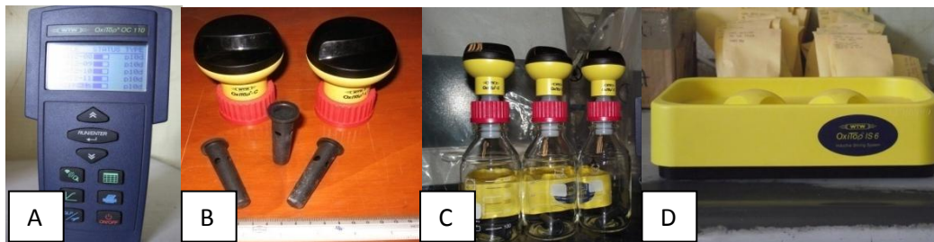
Figura 1. Partes del equipo OxiTop ®: A: control electrónico, B: Cabezal, C: Frascos, D: Base agitadora.
