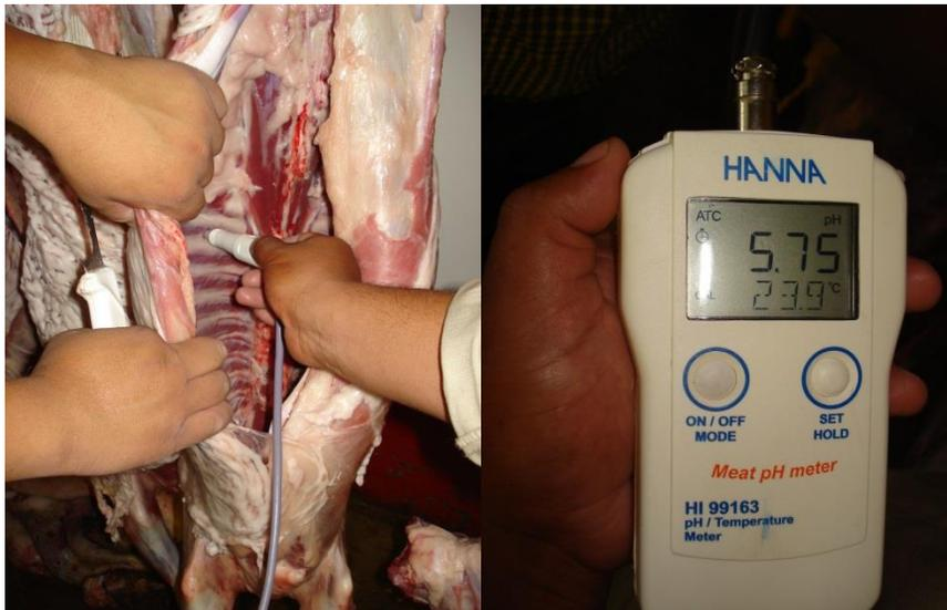
**Figura 11. Lectura del pH en canal con la utilización del potenciómetro**
