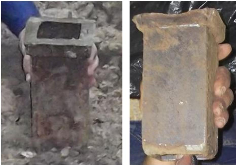
Figura 2.3. Cubos metálicos utilizados para la extracción de las muestras
