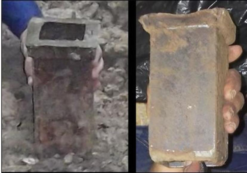
Figura 3.3. Diseño de cubos metálicos utilizados para la extracción de muestras de suelos para la clasificación taxonómica de los organismos
