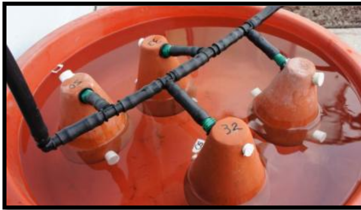
Figura 10. Prueba para observar fugas en el montaje de las capsulas.
