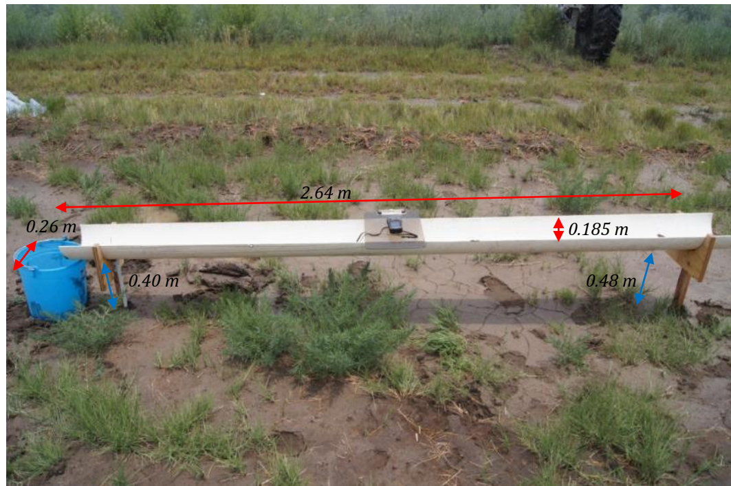
Figura 39. Canaleta pluviométrica instalada para medición de lámina aplicada.
