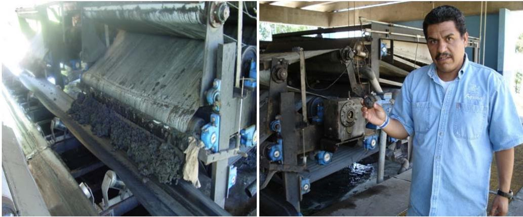
Figura 3.10. Deshidratación de los lodos por medio de filtros banda
