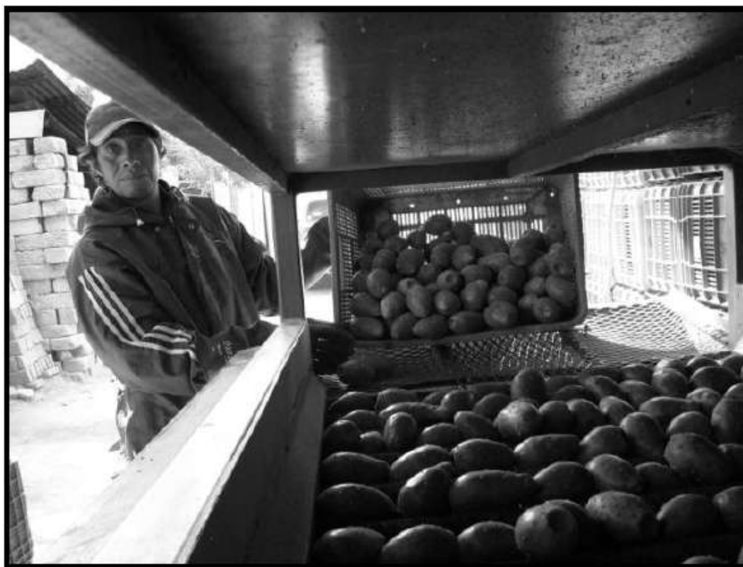
Figura No. 37 Inicio Vaciado de Tunas en la Desespinadora Mecánica (Agos. 26, 2009).
