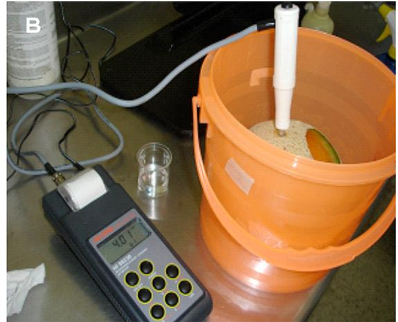
**Figura 3.1 A**, Texturómetro utilizado para medir textura de melones Cantaloupe inoculados con *Rhizopus* sp., y cepa St-3<sup>Km50</sup> de *S. Typhimurium*, almacenados bajo AC<sub>2</sub> (5% O<sub>2</sub> y 15% CO<sub>2</sub>, 80% N<sub>2</sub>) y aire. **B**, Potenciómetro digital con electrodo tipo aguja utilizado para medir pH del punto de inoculación sobre la superficie de melón Cantaloupe. Las mediciones de pH se hicieron después de medir la textura.
