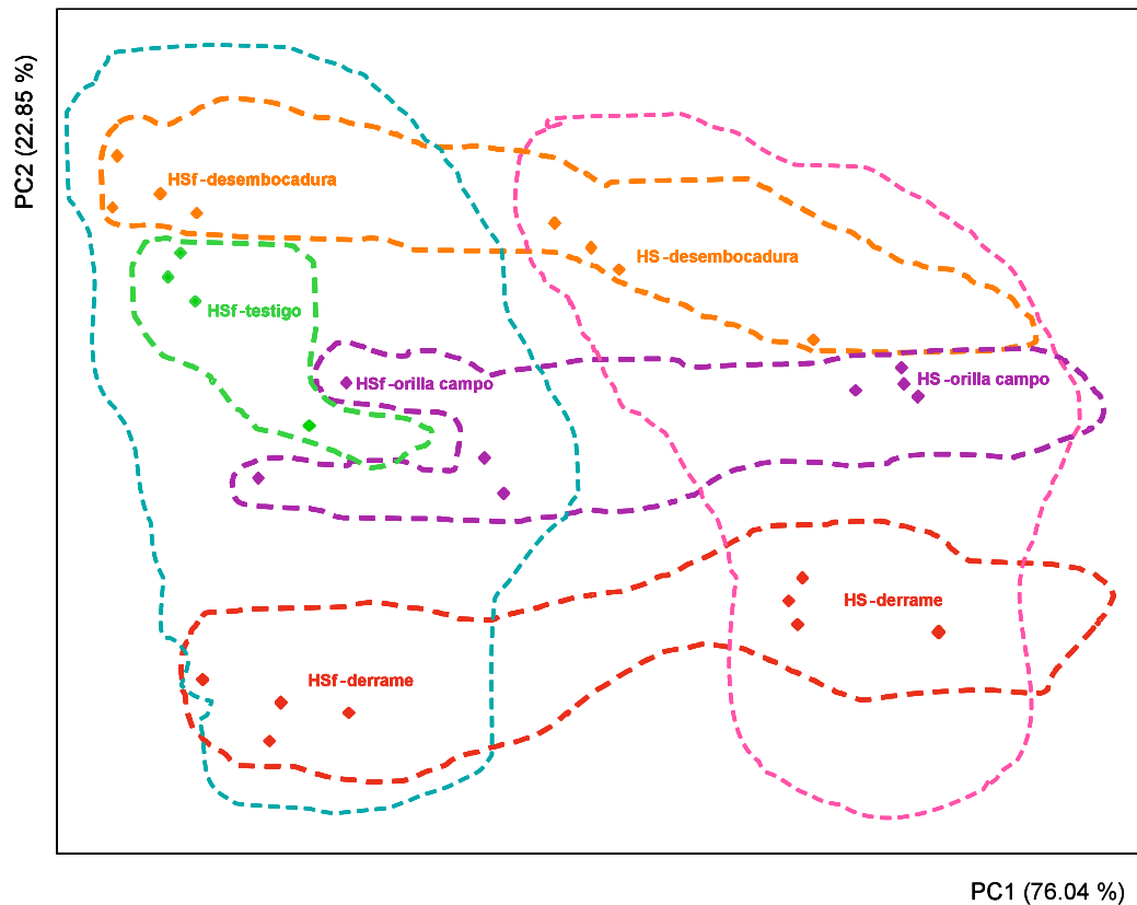
Figura 19. Representación de las puntuaciones de las dos primeras componentes principales del espectro correspondiente a la región NIR de las muestras clasificadas como Histosol.
