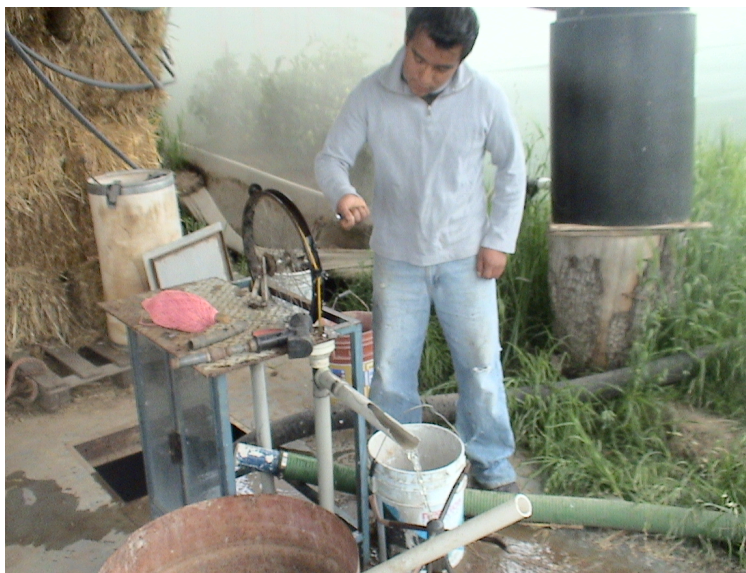
Figura 22. Extracción del agua, utilizando bomba de mecate. Españita, Tlaxcala.
