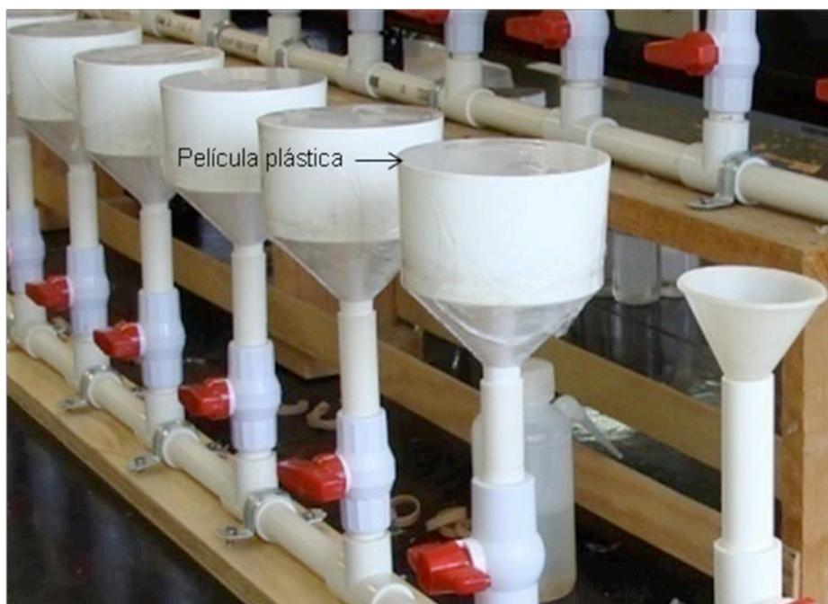
Figura 13. Embudos tapados con película plástica adherible.
