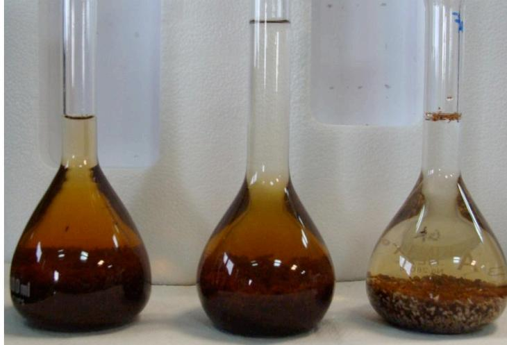
Figura 16. Determinación de densidad real en mezcla de fibra de coco-piedra pómez con partículas de 1-2 mm  $\varnothing$ .
