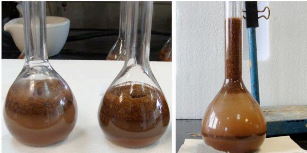
Figura 15. Determinación de densidad real en mezcla de fibra de coco-tezontle con material triturado. Puede observarse como se sedimentó el tezontle y la fibra de coco flotó, lo cual pudo haber ocasionado error en la lectura al aforar.
