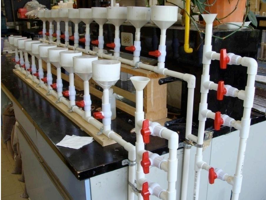
Figura 12. Equipo de succión con embudos de placa filtrante.
