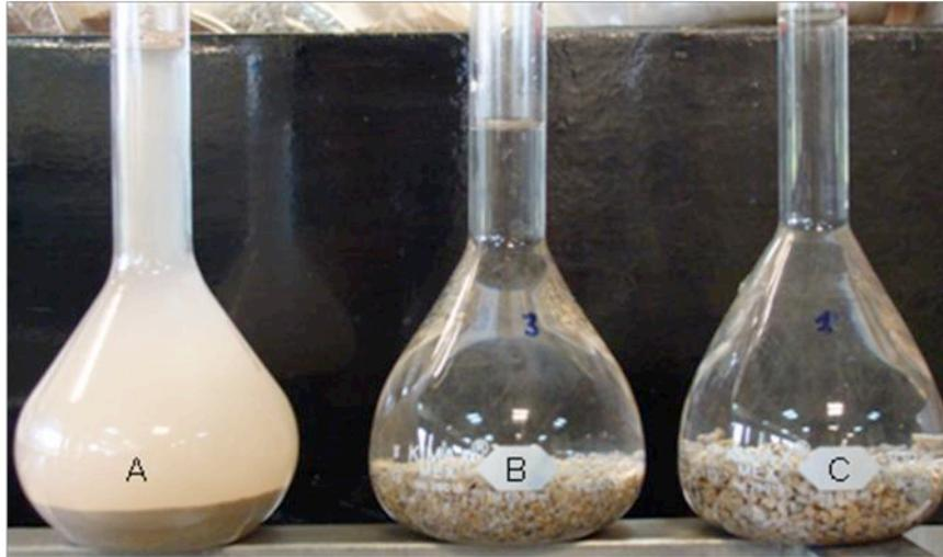
Figura 18. Determinación de densidad real en piedra pómez con el método del matraz aforado. A) Material triturado, B) 1-2 mm y C) 2-3.36 mm.
