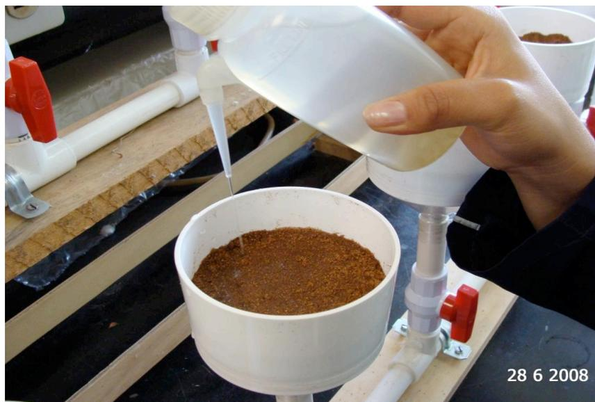
Figura 14. Saturación de la fibra de coco en partículas < 1mm  $\varnothing$  con el uso de piseta, para incrementar el nivel de mojabilidad del material.
