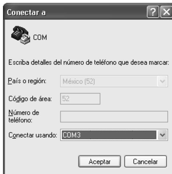
Figura 32. Elección del puerto de comunicación en la *HyperTerminal*.
