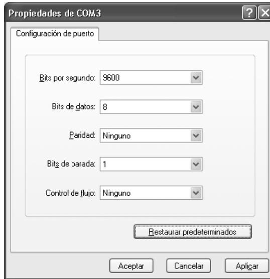
Figura 33. Configuración del puerto en la *HyperTerminal*.
