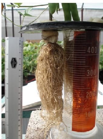
**Figura 9.** Determinación de la longitud y volumen de raíces.
